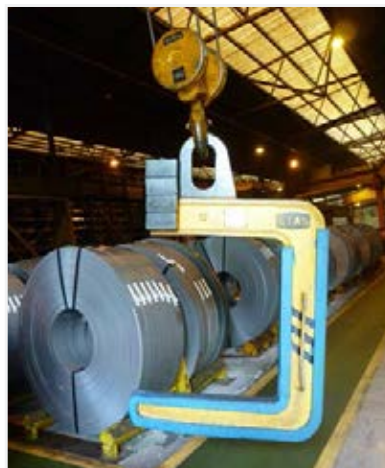
Protección realizada con molde
